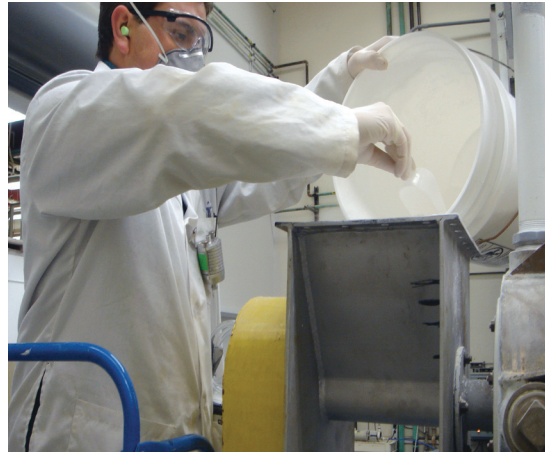
Un trabajador que labora en la producción de nanopartículas viste un equipo de protección dérmico, respiratorio y auditivo y un aparato de muestreo personal de aire durante una operación de vertimiento.
